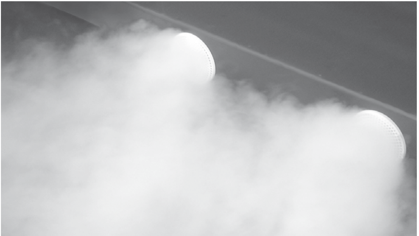
Rys. 2: SZD 125 – wizualizacja wypływającej strugi powietrza na nawiewników
